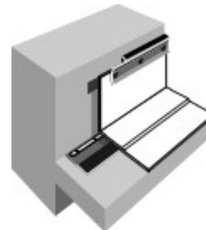
c) Profil de rive avec une bande de pontage Polyback 150mm
